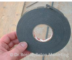
Abb. 6.5 Moosgummi eignet sich besonders für Abdichtungen
