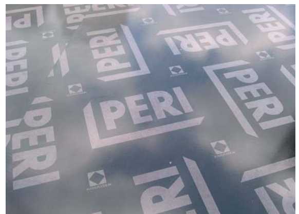
Abb. 1.7 Schalhaut der Klasse SHK 3
