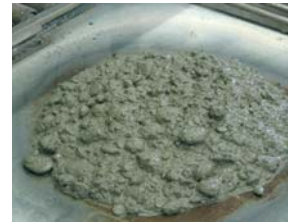
Abb. 8.1 Ein robuster Beton zeigt keine Entmischungserscheinungen
