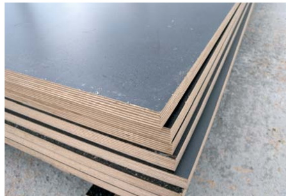
Abb. 3.4 Aufdoppelung einer Rahmenschalung, z. B. mit Mehrschichtplatten
