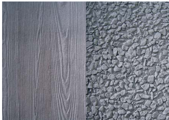
Abb. 2.3 Mit Gummimatrizen gestaltete Betonoberflächen
