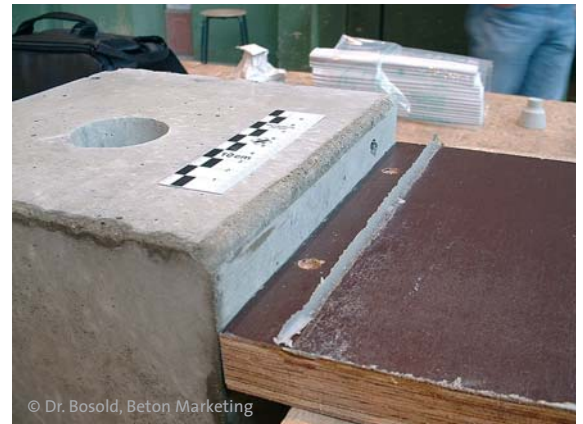
Abb. 6.8 Deutlich dunklere Betonfärbung im Bereich der Silikondichtung
